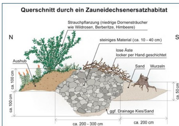
Abbildung 22: Prinzipskizze eines Ersatzhabitats mit Überwinterungsmöglichkeit (LfU, 2020b)
