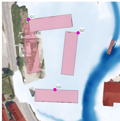
Abbildung 15: maß. Punkte für die Ermittlung der Wasserspiegelhöhen
